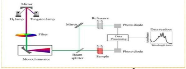
FIG 3:- UV VISIBLE INSTRUMENTATION<sup>[1]</sup>
